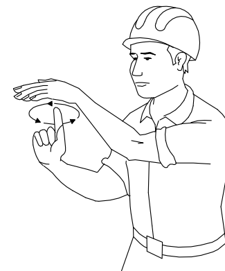
2 LEVANTAR EL AGUILÓN O PLUMA 3 LEVANTAR LA CARGA LENTAMENTE
